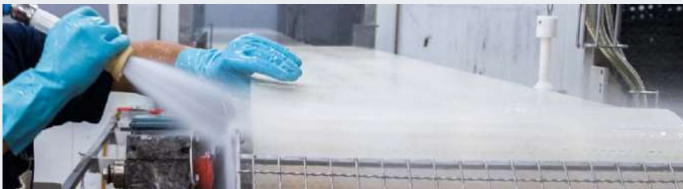
SKFi lahenduse kasutamine aitab vähendada määrdunud määre liikumist mööda toidutsooni survepesu korral.
